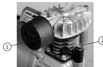
*Рис. 3. Установка воздушного фильтра*
