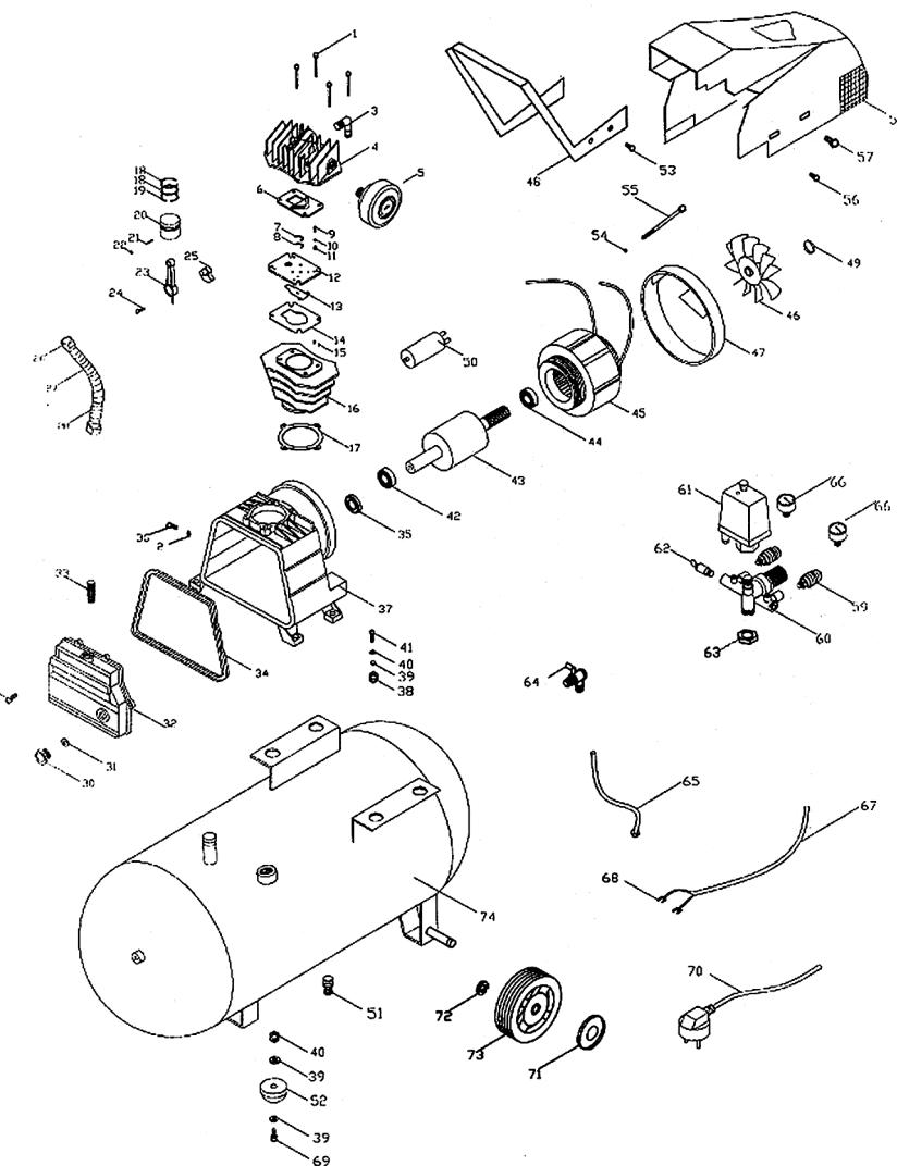
Рис. 6. Схема компрессора 81-152 и 81-170 | Мал. 6. Схема компрессору 81-152 та 81-170 | Fig 6. Layout of compressor 81-152 and 81-170
