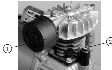
Мал. 3. Установка повітряного фільтра
